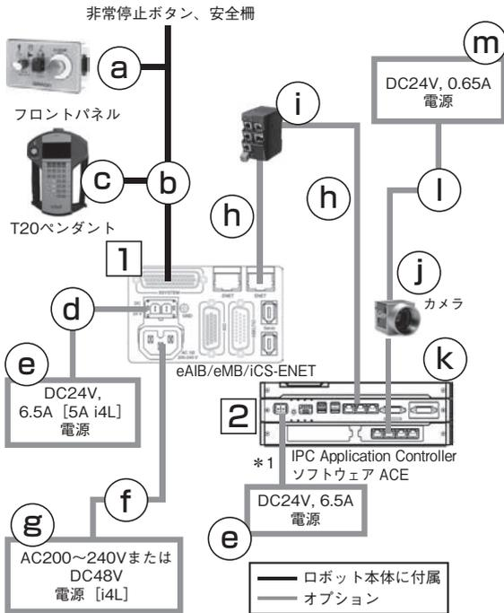
SmartController EXで制御する場合(ビジョンシステム使用時)
