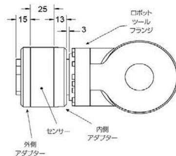
外部アダプタにはロボットツールフランジと同じ取り付け穴が開いています。
